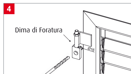
4 FORATURA PER INSERIMENTO TASSELLO Forare con una punta da trapano da Ø16mm. Si consiglia di utilizzare una dima di foratura, non fornita, idonea al tipo di cardine utilizzato.
